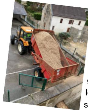
proximité de la station d'épuration. Elles sèchent naturellement par fermentation aérobie. La chaleur générée entraîne l'humidité vers le haut du tas où elle s'évacue sous forme de vapeur. Il faut environ 3 mois pour passer de 50 % d'humidité à 20 %.
