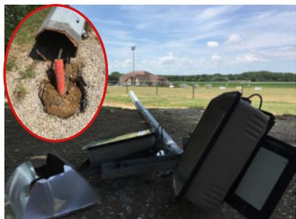
Le problème provenait d'une corrosion importante. Nous avons immédiatement procédé à un contrôle visuel des 3 autres mâts. L'un présentait des piqûres de rouille perforantes et les deux autres un début de corrosion. Pour des raisons de sécurité, il a alors été décidé de déposer dans l'urgence l'ensemble de l'installation.
